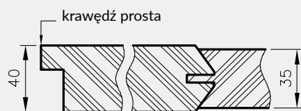
Przekrój poziomy drzwi Elsa
